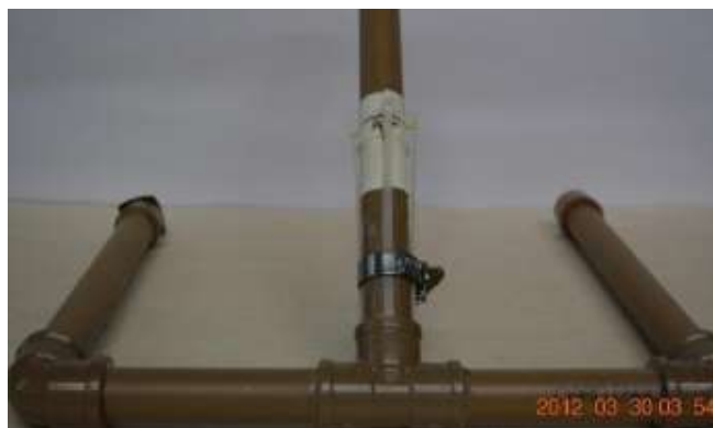
Fig. 19. Base com anel branco posicionado sobre as 4 "cabeças" de nylon.
