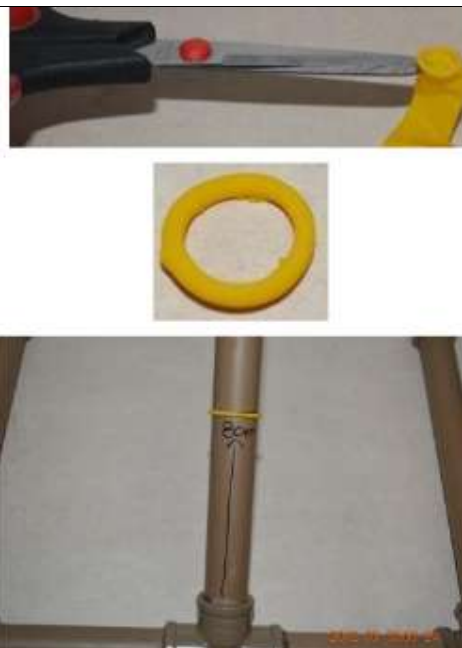
Fig. 16. Base com as 4 abraçadeiras de nylon presas com a abraçadeira de metal. Use 8 abraçadeiras
