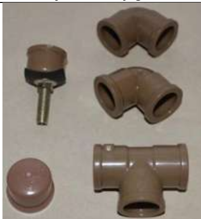
Fig. 9.2 Detalhes da válvula de pneu de bicicleta preso no "cap".
