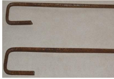
Fig. 20. Estacas que fixam a base de lançamento no solo.
