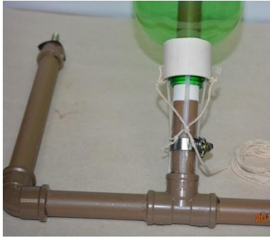
Fig. 19. Base com anel branco posicionado sobre as 4 "cabeças" de nylon.
