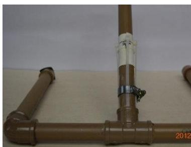
Fig. 16. Base com as 4 abraçadeiras de nylon presas com a abraçadeira de metal. Use 8 abraçadeiras!
