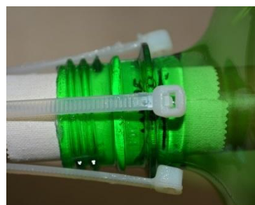
Fig. 17. Posição das cabeças das abraçadeiras sobre o anel sustentação.
